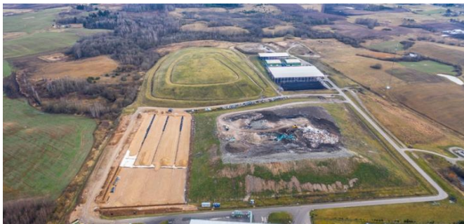
32 pav. Baigiama statyti trečioji nepavojingų atliekų sąvartyno sekcija
